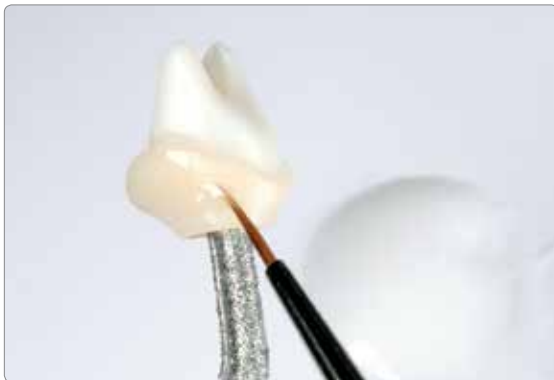
Glasur gleichmässig auf das Emergenzprofil des Hybrid-Abutments auftragen. Unbedingt darauf achten, dass keine Glasur in den Schraubenkanal gelangt.
