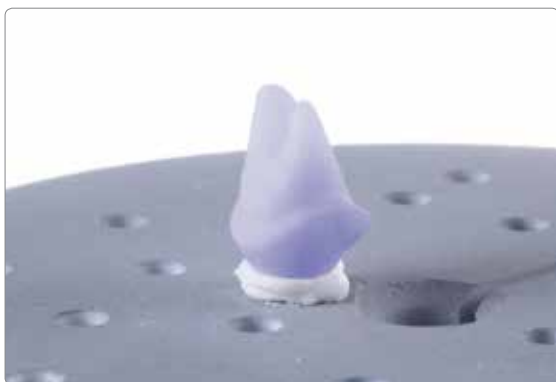
Schnittstelle der Keramikstruktur mit etwas Überschuss mit IPS Object Fix Putty oder Flow füllen und mittig auf dem IPS e.max CAD Crystallization Tray positionieren.
