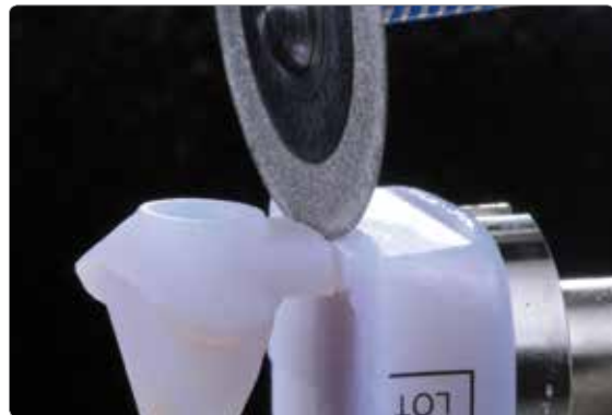
Durchtrennen der Ansatzstelle von basal mittels einer diamantierten Trennscheibe.
