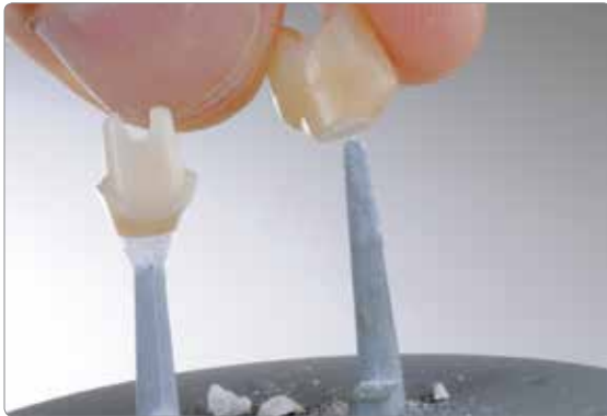
Keramikstrukturen vom IPS e.max CAD Crystallization Pin XS abnehmen.
