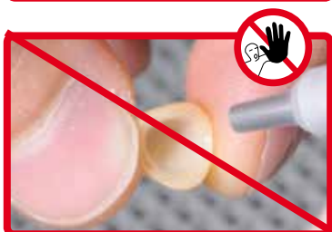
IPS e.max CAD Keramikstrukturen nicht abstrahlen.
