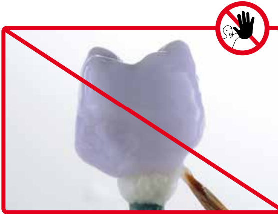
Wichtig: In keinem Fall darf Glasur auf die Klebefläche zur Ti-Base sowie in den Schraubenkanal gelangen, da sonst Passungsprobleme auftreten.
