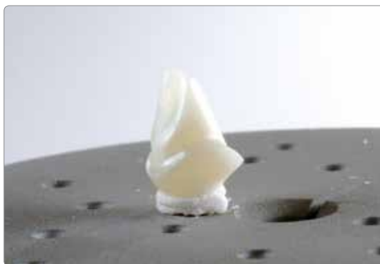
Nach Ablauf des Kristallisationsprogramms Brenngutträger aus dem Ofen entnehmen und Objekt abkühlen lassen
