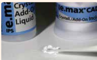
Anmischen des IPS e.max CAD Crystall./Add-On mit IPS e.max CAD Crystall./Add-On Liquid zu einer modellierfähigen Konsistenz
