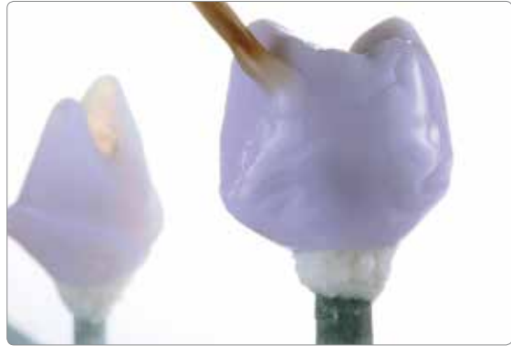
IPS e.max CAD Crystall./Glaze Paste gleichmässig auf das Emergenzprofil des Hybrid-Abutments bzw. die Aussenfläche der Hybrid-Abutment-Krone auftragen.
