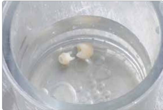
Anhaftende Rückstände mit Ultraschall im Wasserbad ...
